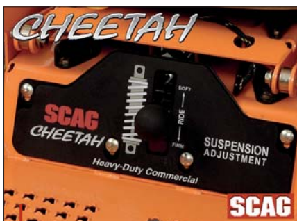
Tvrdost odpružení se nastavuje podle hmotnosti obsluhy
