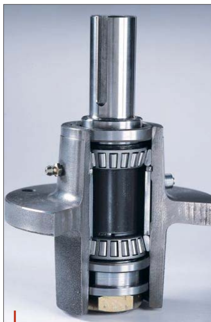
Uložení hřídele žacích nožů je konstruováno současně jako pojistka
